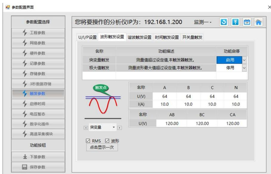
图 5.10 波形触发设置界面
